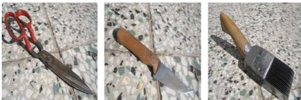
شکل ۲۶ سمت راست: شانه گلیم بافی و قالیبافی. وسط: چاقوی گلیم و قالیبافی. سمت چپ: قیچی
