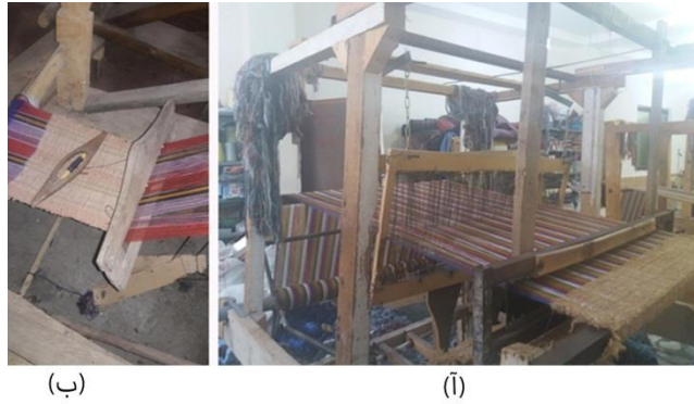
تصویر ۵- نحوه عبور تارها از میلیمیک و قرار گیری شانه فلزی در دستگاه امروزی کرچال (آ) و مشابه آن در سنتی (ب). (نگارنده)
