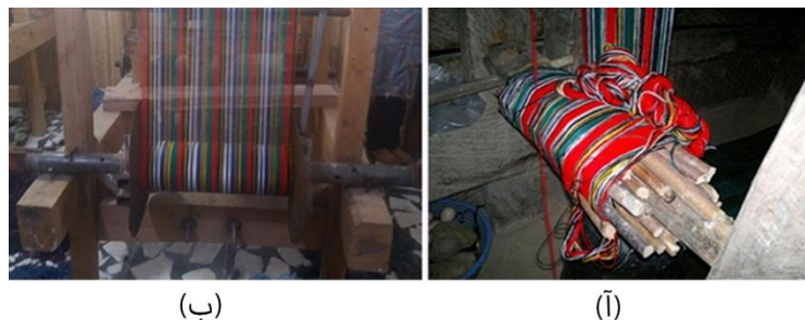
تصویر ۷- نورد یا نرد در دستگاه پارچه بافی کرچال سنتی (آ) و امروزی (ب) (نگارنده)
