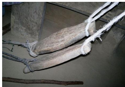
تصویر ۶- پدالها در دستگاه پارچه بافی کرچال سنتی (مهدی زاده، ۱۳۹۶)
