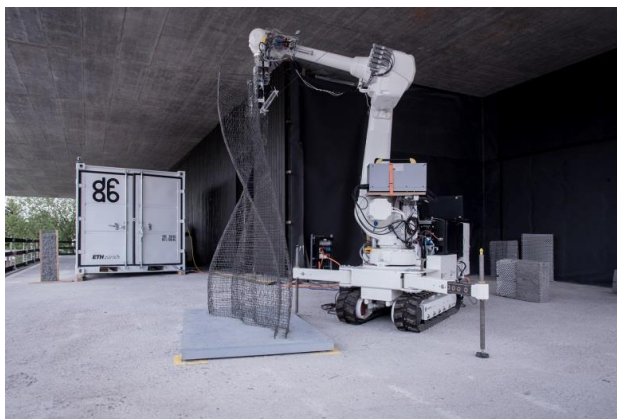
شکل ۹- ساخت دیجیتالی قالب با چاپگر سه بعدی، زوریخ، سوئیس
