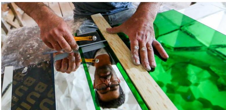
تصویر ۵. هنرمند آینه کار در حال استفاده از ابزار الماس آینه بر و خط کش برای برش آینه
