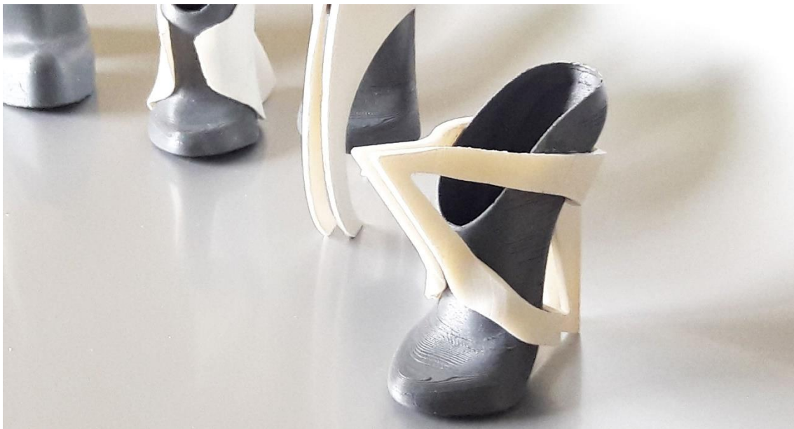
شکل ۵ و ۶ - ماکت‌ها در ابعاد یک دوم، تولید شده توسط پرینت سه بعدی
